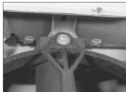
3.4 Cooling fan retaining bolt
